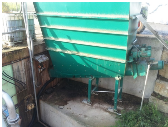
Foto 45: Indførdning af fast biomasse. Det er her en fordel af sneglene kan arbejde med tyngdekraften.
