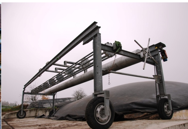
Foto 9: Rulleudstyr til at fjerne og udlægge dug på biogasreaktoren.
