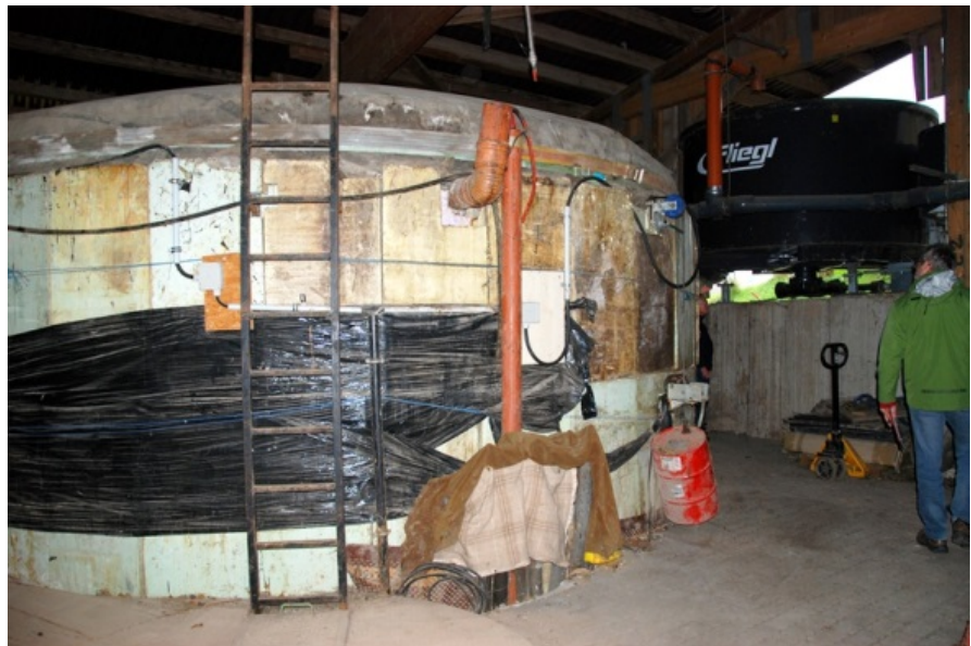
Foto 51: Et hjemmebygget men velfungerende koncept fra 1994. Reaktoren er 10 m dyb og 6 m i diameter.
