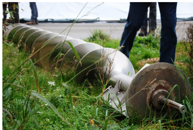
Foto 25: Indfødningsnegle slides hurtigt, selvom det er rustfrit stål.
